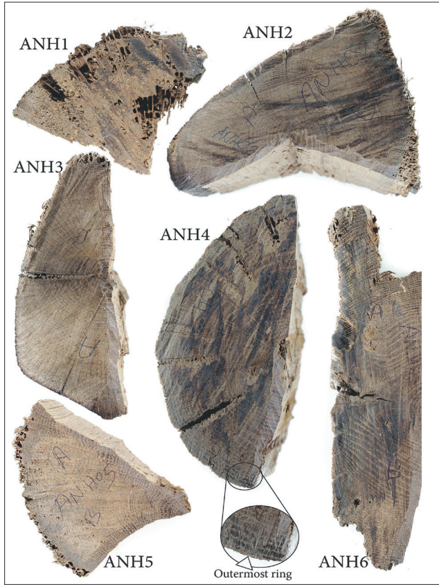
Figure 2. The examined 6 oak beams from Anadolu Hisarı. Only one sample, ANH4, has the outermost ring. The outer parts of the other samples were decomposed. / Anadolu Hisarı'ndan alınarak incelenen 6 hatıl örneği. Sadece ANH4 adlı hatıl örneğinin en dış halkası bulunmaktadır. Diğer örneklerin dış halkaları bozulmuştur.
